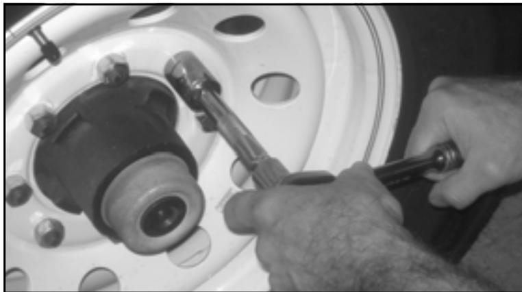
*Figure 7-3. Remove the lug nuts.*
